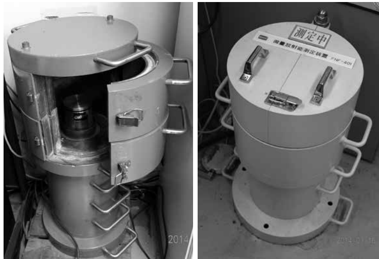
たんぽぽ舎の微量放射能測定器（左：1号器、右：2号器）
